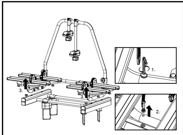
Lösen Sie zuerst die 4 Inbusschrauben (1.) mit dem mitgelieferten Inbusschlüssel und entfernen Sie die Schrauben (2.).
