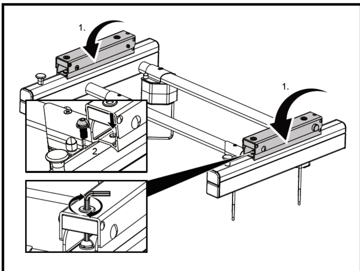
Bevestig daarna de kanteladapters aan achterzijde. Dit gaat eenvoudig door de kanteladapter te openen. Druk daarvoor op de knop (1.) en open de kanteladapter (2.). Gebruik nu de meegeleverde inbusbouten M8x25, veerringen M8 en ringen M8 en bevestig deze (3.).
