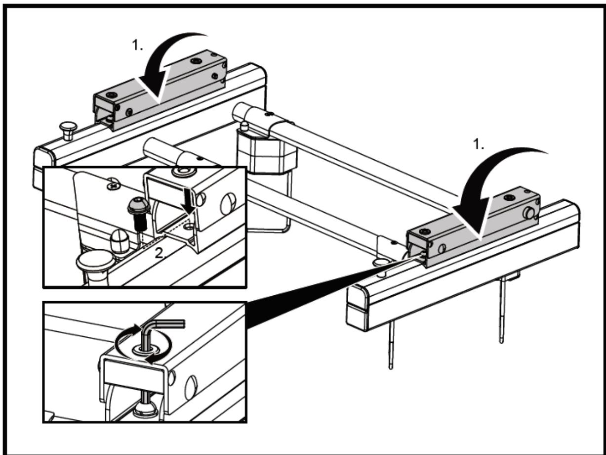
Befestigen Sie dann die Abklappaufnahme an der Rückseite. Dies geschieht einfach durch Öffnen der Abklappaufnahme. Drücken Sie dazu die Taste (1.) und öffnen Sie die Abklappaufnahme (2.). Verwenden Sie nun die mitgelieferten Inbusschrauben M8 x 25, Federringe M8 und Unterlegscheiben M8 und befestigen Sie diese (3.).
